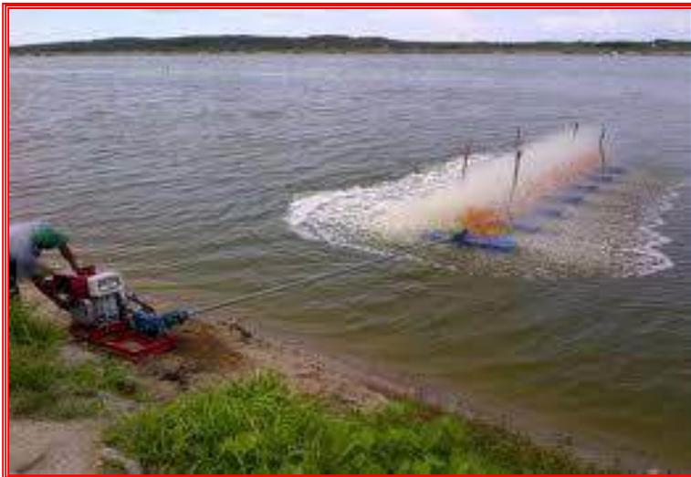
Fig.9. Aireadores de paleta en embalse dedicado al cultivo de tilapia, sistema semi intensivo.
