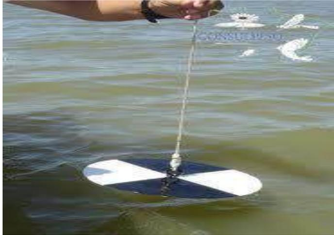
**Foto No.10** Disco Secchi para medición de la transparencia
